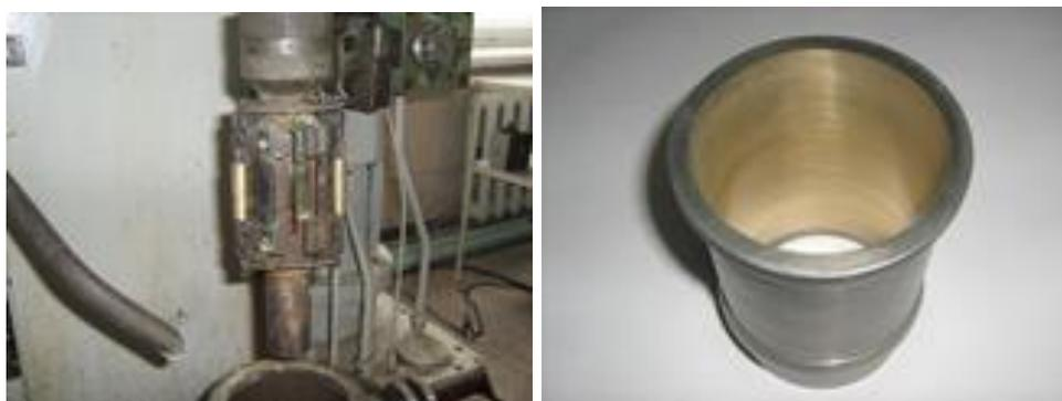
Рисунок 3. Латунирующая головка на хонигвальном станке и латунированная гильза.
