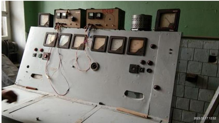
Рисунок 1. Гальваническая установка для исследования электроосаждения металлов
